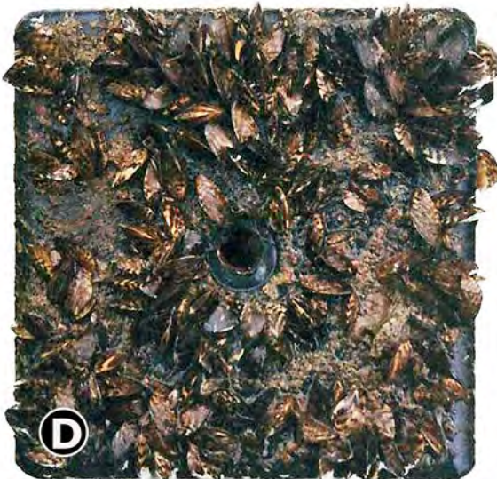
Abb. 5: A Versuchsanordnung der Antifoulingwürfel. Von links nach rechts: Seeguardian, Mikron CSC, MPX, VC-Aqua 12, VC 17m, Kontrollwürfel. B Unterseite des VC-Aqua Würfels aus dem Wallersee. Dezember 1998. Deutlich von Dreissena besiedelt. C Unterseite des VC-Aqua Würfels aus dem Fuschlsee. Dezember 1998. Köcherfliegenlarven um die Mitte zentriert. D Unterseite des Kontrollwürfels aus dem Wallersee. Dezember 1998. Starker Algenbewuchs und Dreissena . E Unterseite des Kontrollwürfels aus dem Fuschlsee. Dezember 1998. Köcherfliegenlarven und Dreissena , sehr wenig Algen.
